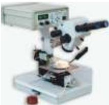
УМС-ТМИ-01/50/500 тестер механических испытаний.
