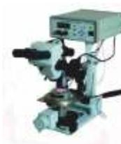
УМС-ТМИ-02/5000 тестер механических испытаний для контроля на сдвиг полупроводниковых кристаллов после монтажа на носитель (плату).
