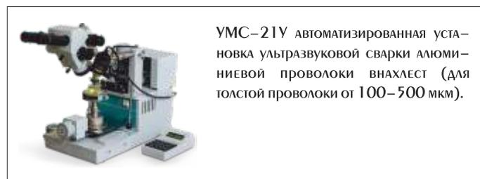
УМС-21У автоматизированная установка ультразвуковой сварки алюминиевой проволоки внахлест (для толстой проволоки от 100–500 мкм).
