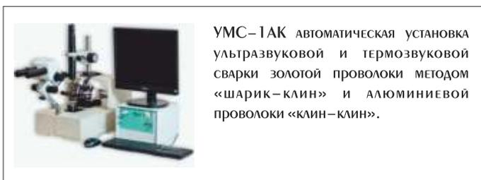
УМС-1АК автоматическая установка ультразвуковой и термозвуковой сварки золотой проволоки методом «шарик-клин» и алюминиевой проволоки «клин-клин».
