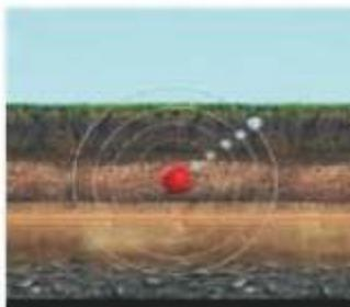
Маркер пассивный шаровой, серии STEL-SMP... - это техническое устройство в корпусе из пластика сферической формы, устойчивого к деформациям.
