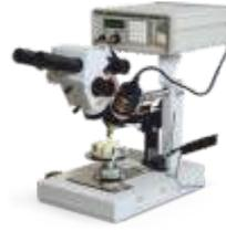
УМС-3КПМ механизированная установка микроконтактной сварки.
