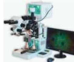
УМС-100П автоматизированная установка точного монтажа полупроводниковых кристаллов в корпус прибора или на технологический носитель – плату.
