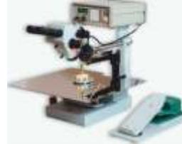
УМС-4КП установка контактной микросварки (для монтажа крупнобаритных приборов с глубоким колодцем).
