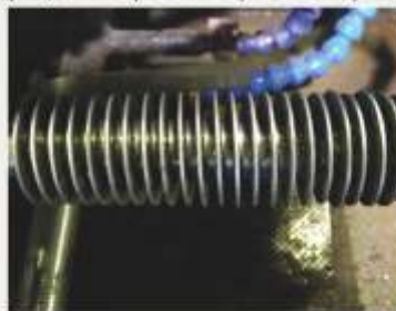
Оребренная труба 16x2 ст.12Х18Н10Т, лента 1x11 ст.08Х18Н10
