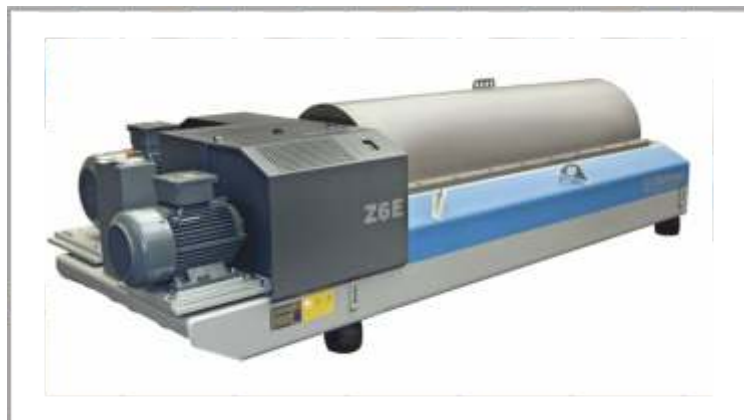
Рис. 1. Трикантер (Tricanter®) Flottweg
