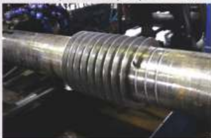
Оребренная труба 114x6 ст.12Х1МФ, лента 2x20 ст.08КП
