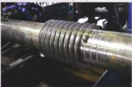
Оребренная труба 114x6 ст.12Х1МФ, лента 2x20 ст.08КП
