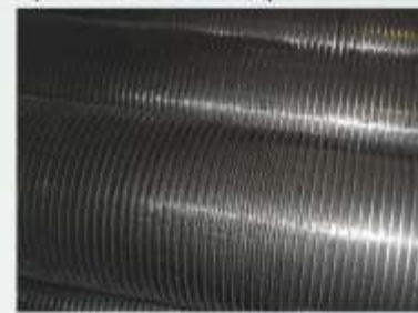
Оребренная труба 159x8 ст.20, лента 1,5x16 ст.08КП
