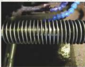
Оребренная труба 16x2 ст.12Х18Н10Т, лента 1x11 ст.08Х18Н10
