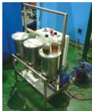
Установка ФКС-03(Б). Очистка трансмиссионного масла испытательного стенда на Петербургском тракторном заводе
