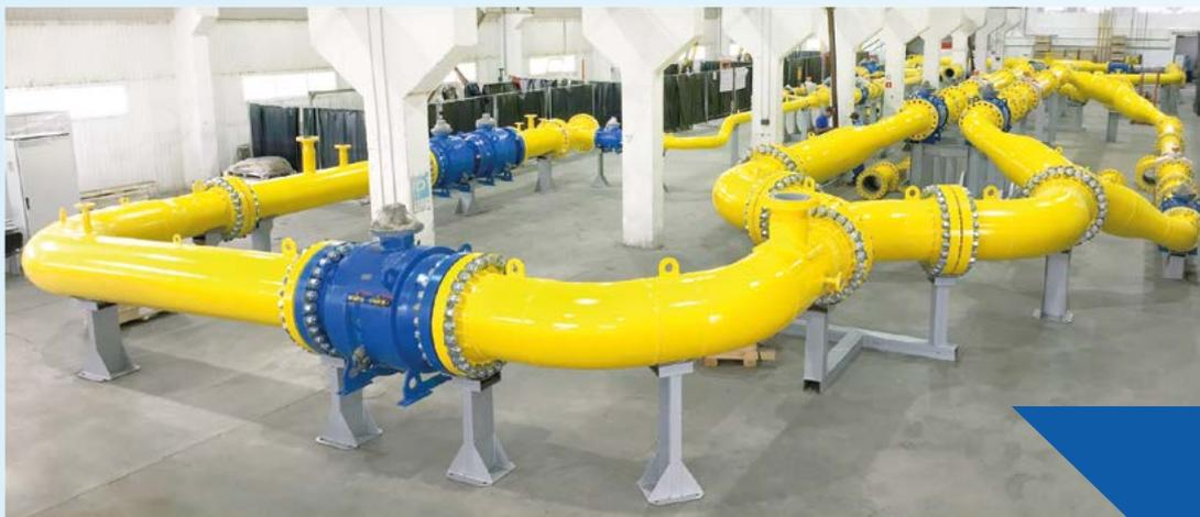
Поверка и калибровка расходомеров широкого диапазона применения на рабочем давлении до 10 МПа: от узлов учета промышленных потребителей до расходомерных комплексов приграничных ГИС
