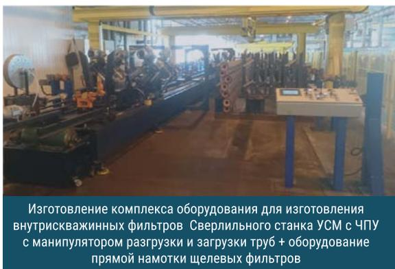
Изготовление комплекса оборудования для изготовления внутрискважинных фильтров. Сверлильного станка УСМ с ЧПУ с манипулятором разгрузки и загрузки труб + оборудование прямой намотки щелевых фильтров
