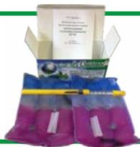
Для химического экспресс-анализа воздуха и газовой смеси с помощью индикаторных трубок при пониженных температурах (ниже рабочих условий). Позволяет использовать индикаторные трубки при температуре от минус 8 до плюс 10 °С. Состав: грелка солевая многозарядная саморазогревающаяся, термометр, трубка силиконовая длиной 4 см для соединения индикаторной трубки и фильтрующей трубки, документация.
