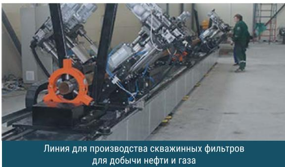
Линия для производства скважинных фильтров для добычи нефти и газа
