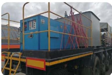
Задняя площадка и «гусачная часть» в представленном экземпляре используется для размещения Пароводяной технологической мойки (ПВТМ PRETOR-37) а также барабана для намотки силового кабеля подключения ПВТМ. Все рабочие зоны полуприцепа оборудованы лестницами, ограждениями, защитными кожухами движущихся частей и механизмов.
