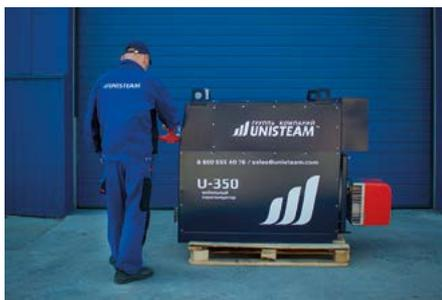
собой водотрубный прямоточный паровой котел со спиральным змеевиком, расположенный горизонтально в нижней части установки. Питательная вода подается в змеевик котла поршневым насосом высокого давления, и разогревается блочной автоматизированной горелкой. Через пять минут после включения парогенератор UNISTEAM готов к работе.
