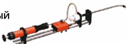
Для отбора проб газовых сред из труднодоступных мест с последующим их анализом с применением индикаторных трубок совместно с насосом-пробоотборником НП-3М. Обеспечивает удобство выполнения химического экспресс-анализа в труднодоступных местах, не имеющих отрицательного давления, таких как кабельные колодцы, склады, баки, трубопроводы, система вентиляции цехов и т.п.
