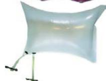
Для отбора проб газа (воздуха, а также паровоздушных и газовой смеси) с целью их кратковременного хранения и доставки к месту последующего анализа. Благодаря оснащению двумя штуцерами с зажимами, а также застежкой-«молнией», позволяет отбирать пробы из баллонов и газовой магистрали с избыточным давлением, а также непосредственно из воздуха при атмосферных условиях.
