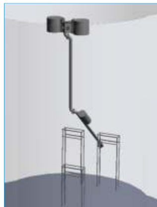
Понтонный скиммер с подвижной дренажной системой для резервуара с моноэтаноламином
