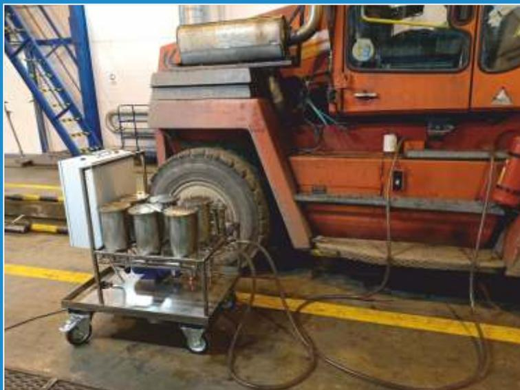
Рис. 2 Установка ФКС-О3(Б)-08). Очистка гидравлического масла погрузчика во время планового ТО
