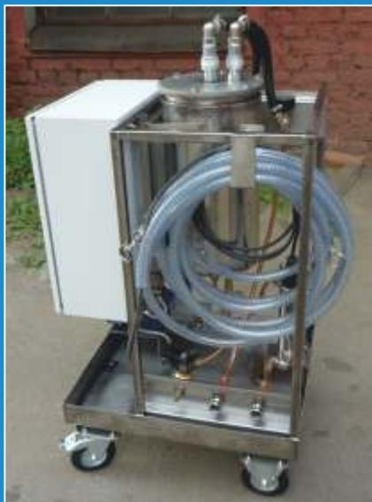
Рис. 1 Установка ФКС-ДТ-08 для очистки дизельного топлива от воды и механических примесей
