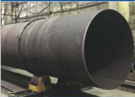
Схема трубы стальной электросварной с ребрами жесткости
