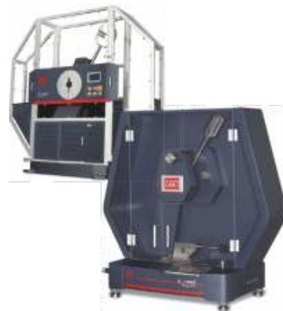
Копры MTS Exceed® серий E21 и E22 обеспечивают точное определение ударной вязкости металлических и пластиковых образцов. Испытания по Шарпи и Изоду. Копры комплектуются молотами с энергией удара от 1 до 450 Дж.
