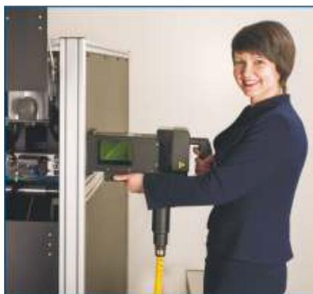
Для нанесения маркировки с помощью **Штрих Контакт** оператор держит маркирующий модуль в руках и прижимает его к поверхности маркируемого изделия. В некоторых случаях **Штрих Контакт** может использоваться для очистки поверхности изделий от ржавчины, краски и других покрытий.
