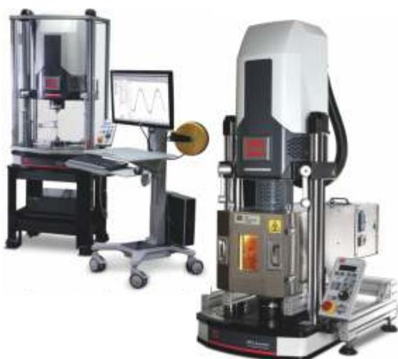
Компактная настольная электродинамическая система MTS Acumen® для проведения усталостных испытаний с нагрузкой до 3 кН. Проста и удобна в работе.
