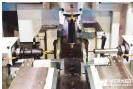
Базовая версия этого станка имеет 3 шпинделя для одновременной обработки с 3-х сторон (стенка и полки) не только двутавра, но и профиля прямоугольного сечения, уголка, полосы. Сквозное сверление профиля прямоугольного сечения и нижней стенки прямоугольной трубы может производиться с использованием специ-
