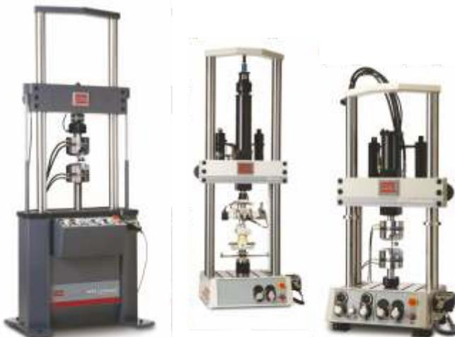
Сервогидравлические машины MTS Landmark® имеют широкий ряд возможностей для проведения динамических и статических испытаний. Машины можно легко настроить с учетом требований к испытаниям материалов или компонентов, выбирая требуемые значения усилия, производительности сервоклапанов и насосной станции, программное обеспечение и принадлежности.
