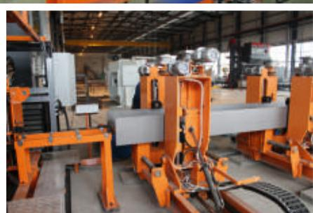
Сварная балка переменного сечения позволяет уменьшить вес несущих конструкций до 35%.
