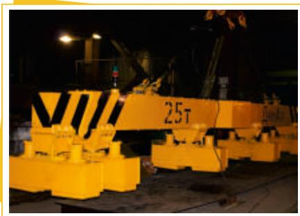
Траверсы комплектуются системой управления, которая позволяет включать все или выбирочно отдельные грузоподъемные магниты и подбирать грузоподъемность таким образом, чтобы обеспечить подъем только одного листа из пачки.
