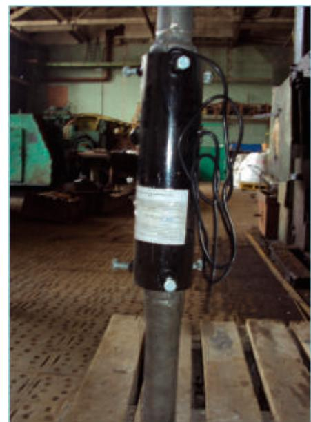
Рис.2 Сцепное устройство для сборки гирлянд.
