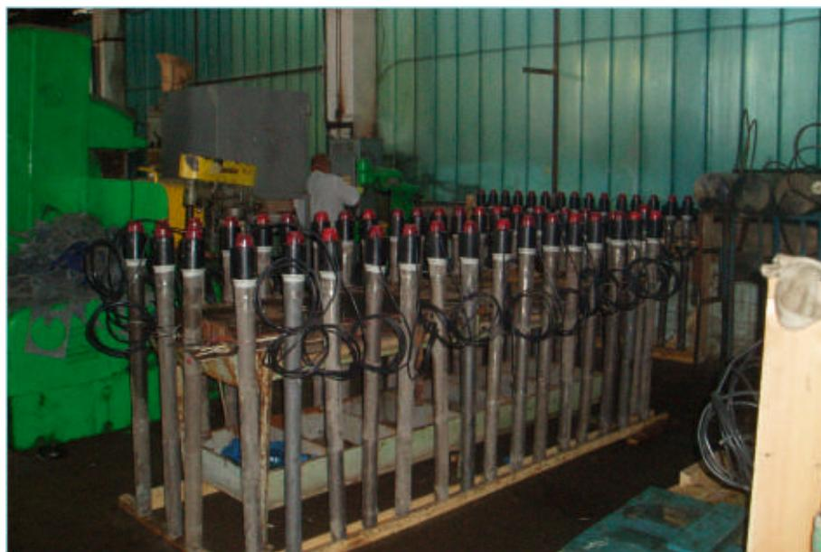
Рис.1 Участок сборки анодных заземлителей.
