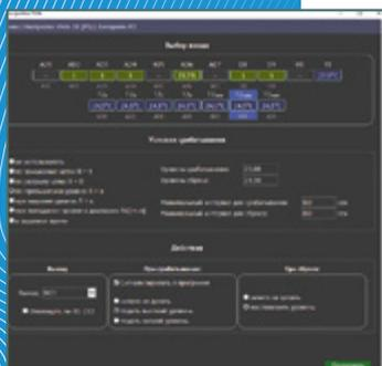
Приложение может работать с целой группой устройств, соединённых в одну или несколько сетей, комбинируя соединения как по RS-485, так и через Ethernet.
